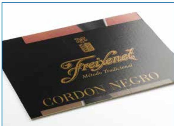
Papier w całości powlekany; 5 kolorów + lakier na bazie wody; 9000 arkuszy/godz. dla Masterflex 160
