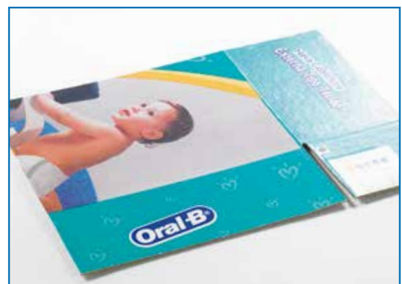
Vollgestrichenes Papier; 4 Farben + Wasserlack, 5500 Bogen/h inline auf DRO 1628 NT
